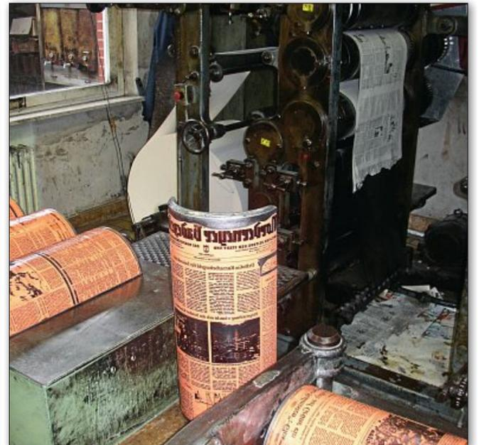
An den Zylindern, die mit Nyloprintplatten beklebt sind, ist zu erkennen, dass zuletzt nur noch mit Offset-Filmen gearbeitet wurde. Sie wurden auf die fotoempfindlichen Nyloprintplatten belichtet und chemisch ausgewaschen, bevor sie dann auf die Druckwalzen kamen.
