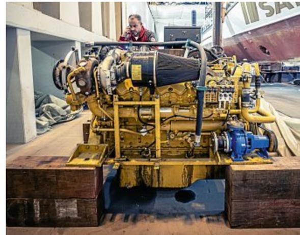
Die Hauptmaschine wurde zur Instandsetzung ausgebaut.
