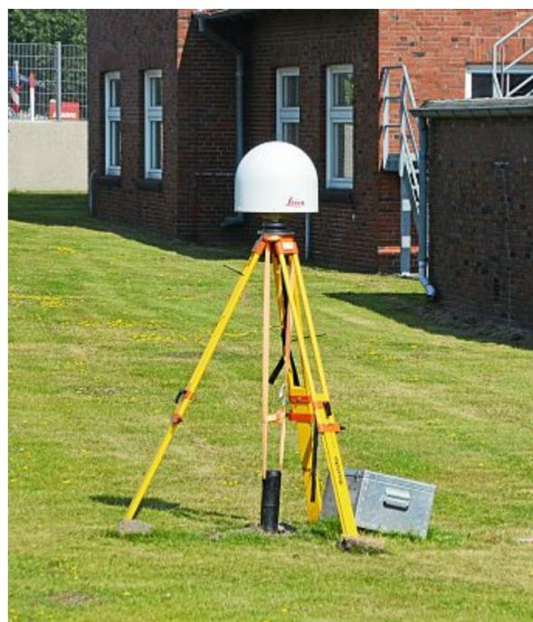
Wie ein Pilz steht er da, der mobile geodätische Festpunkt hinter dem Tonnenhof. Bundesweit läuft derzeit eine Kampagne, in der die Geodätischen Grundnetzpunkte (GGP) neu über Satelliten vermessen werden. Diese Grundnetzpunkte sind über das gesamte Bundesgebiet verteilt. Bei der Kampagne handelt es sich um eine hoheitliche Vermessung, die durch die Landesvermessung vorgenommen wird. *bd*
