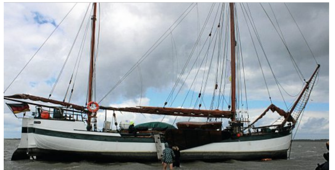
Ein platter Boden sorgt dafür, dass das Plattbodenschiff durch flache Gewässer fahren kann.
