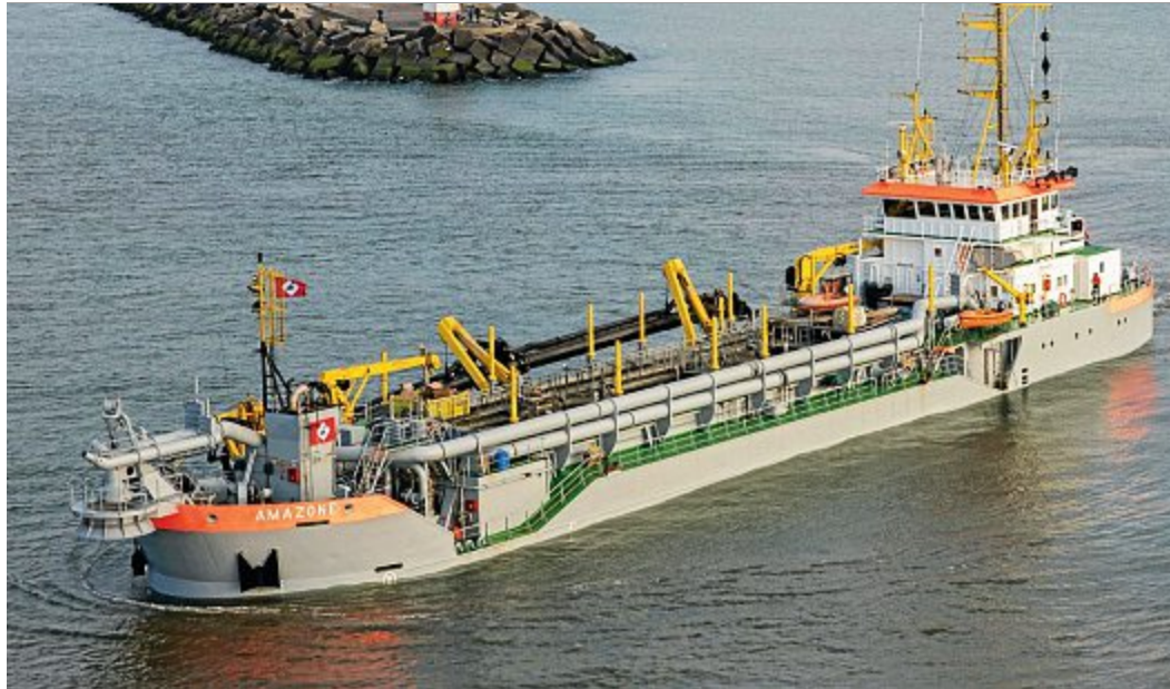
Der Laderaumsaugbagger „Amazone“ soll den Sand für die Aufspülung entnehmen.
