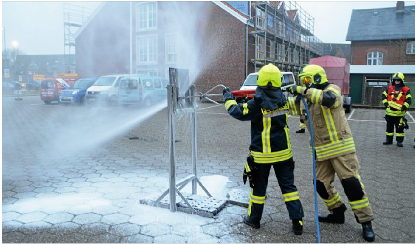
Wie ein warmes Messer durch weiche Butter gleitet das Gemisch aus Sand, Stahl und Wasser durch die Metallplatte.
