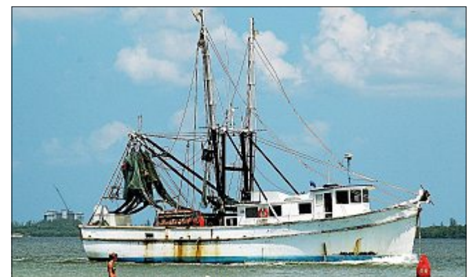
Mit diesem mittelgroßen Fischereiboot werden Garnelen gefangen. Die Netze sieht man am Heck des Bootes. FOTO: PIXABAY
