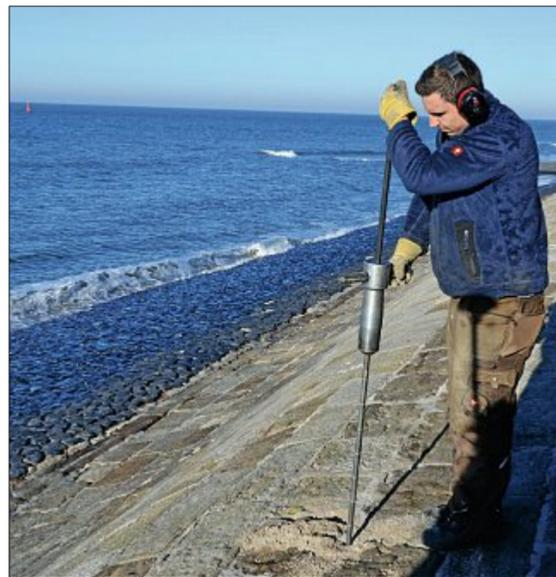
Mit mehreren Schlägen wird die Messsonde durch das Bohrloch in den Boden unter dem Bauwerk getrieben. Die hierfür erforderliche Energie verrät den NLWKN-Mitarbeitern unter anderem, wie dicht das Bodenmaterial ist. FOTO: SÖRRIES
