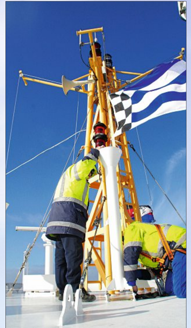
An der Flaggenautomatik muss ein Drahtseil ausgetauscht werden.
