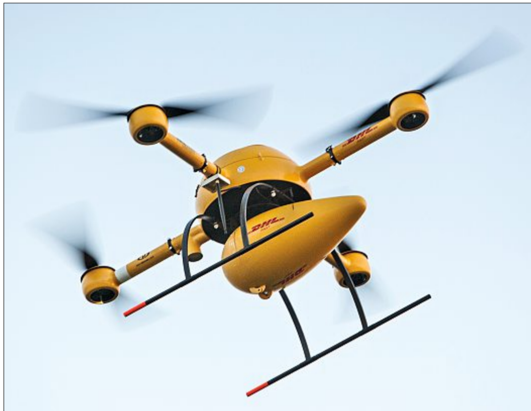
Der Paketkopter im Landeanflug auf Juist. Vier Rotoren halten das knapp fünf Kilogramm schwere Fluggerät in der Luft. FOTO: DPA
