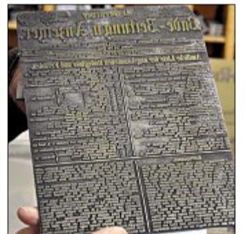
Die Matrize einer Seite der „Bade-Zeitung und Anzeiger“ aus dem Juni 1868.
