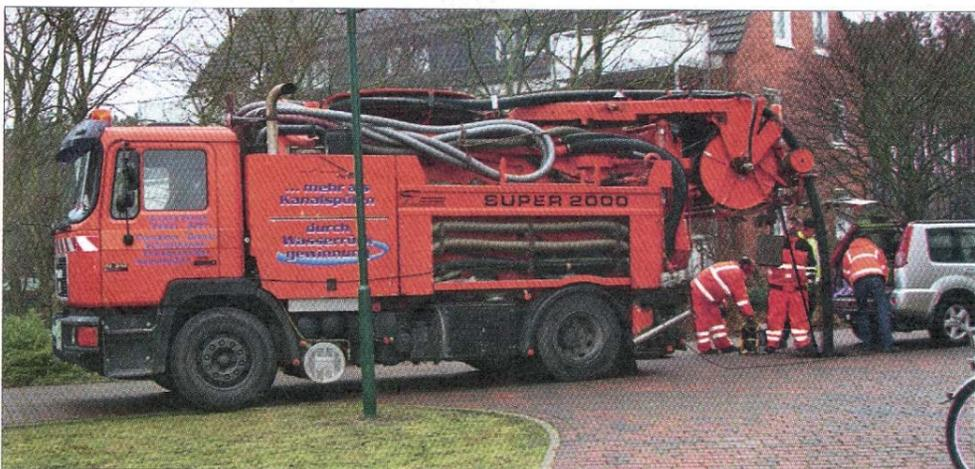
Spülung eines Abwasserkanals heute – mit gleichzeitiger Kamerabefahrung.
