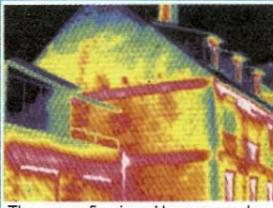
Thermografie eines Hauses vor der Fassadendämmung.
