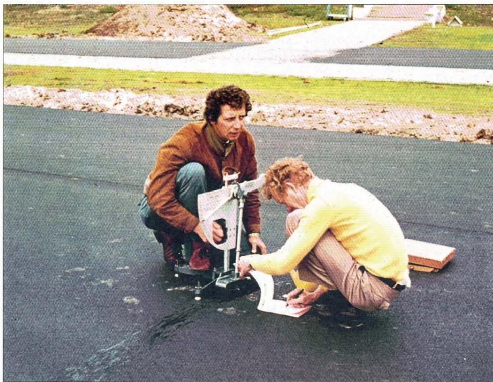
Messung der Rauigkeit der Oberfläche bei Nässe.
