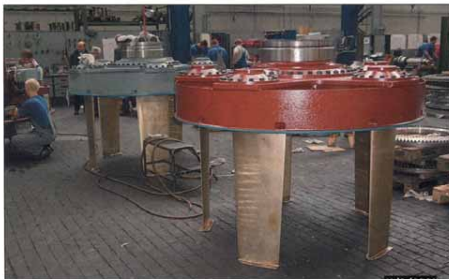
Das ist einer der vier Antriebe bei dem die lamellenartigen Antriebsflügel senkrecht und nicht mehr waagrecht wie Propeller im Wasser rotieren.
