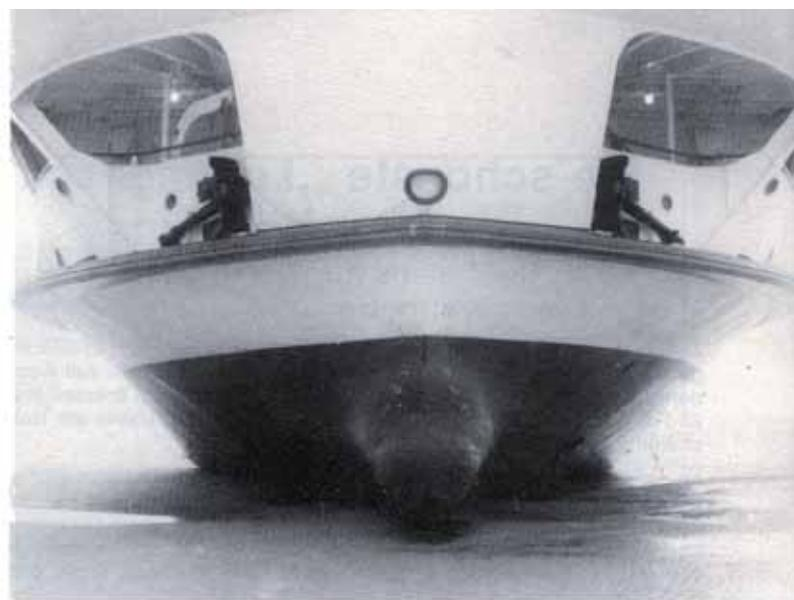
Der Bug der „FRISIA V“ und der Bug der „FRISIA I“: obwohl beide Auto- und Personenfähren Schwesterschiffe sind, gibt es bei den Rümpfen im Unterschiffsbereich deutliche Konstruktionsunterschiede.
