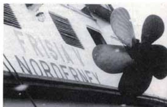
Das Auf- und Abheben der bronzenen Schiffspropeller, die für den Hauptantrieb gut 6 Zentner und für die seitlichen Schotelantriebe knapp 4 Zentner wiegen, erfolgte jeweils vom Oberdeck der Fähren.
