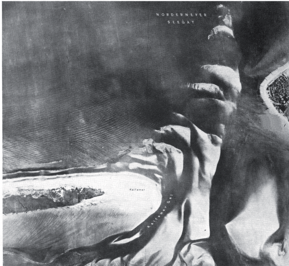
Luftbildaufnahme des Norderneyer Seegats mit Juist (links) und dem Westende Norderneys (rechts). Durch das Seegat strömen mit jeder Tide rund 500 Millionen Kubikmeter Wasser ein und aus. Die Platen sind Teile des Riffbogens und veranschaulichen den Transportmechanismus des Sandes im Bereich des Nord-Süd-gerichteten Tidestromes.
